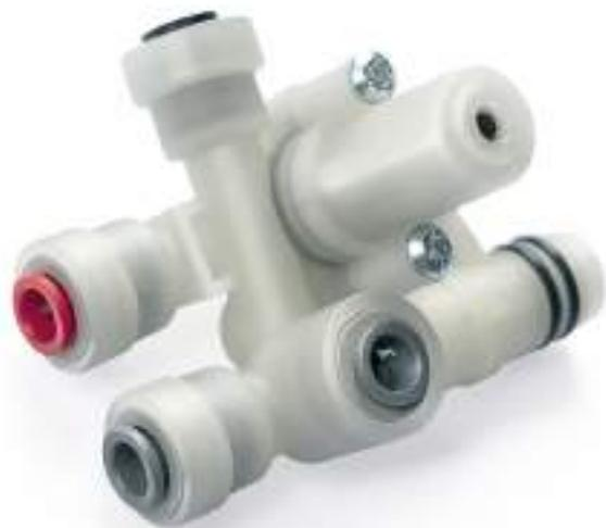
Il modulo d'uscita brevettato gestisce lo scarto in modo automatico variando, in accordo alle condizioni dell'acqua in ingresso, il quantitativo d'acqua da scartare. Lo SMART DRAIN, gestendo sempre il corretto livello tra permeato e scarto aiuta la membrana a durare più a lungo e permette al sistema di lavorare a pressione costante. Grazie a questo sistema innovativo, la macchina lavora meglio e necessita di meno interventi tecnici.
